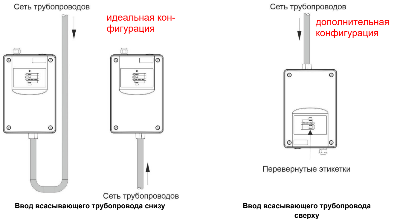
Рис. 20. Монтажное положение и вводы для труб на коробке оповещателя
