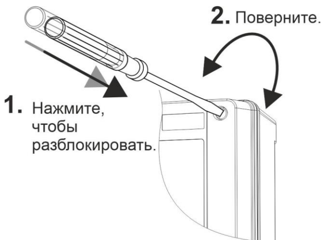
Рис. 25. Вращение фиксатора с защелкой и пружиной
