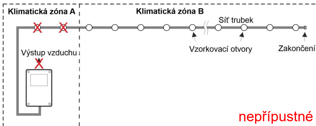
Obrázek 19 Veškeré vzorkovací otvory a výstup vzduchu musí být ve stejné klimatické zóně
